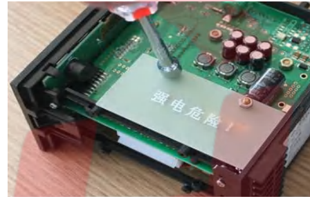
图 1.用工具拆开两颗螺母
